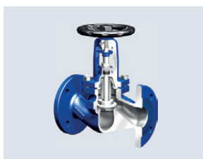
FABA®: das Faltenbalgabsperventil mit „Cut-Effekt“ (Linien-Abdichtung des konischen Kegels auf dem Sitzring).
