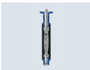
Zweiteilige Welle mit dreifacher Wellenlagerung. Das Wellenende ist als Vierkant mit Stellscheibe ausgeführt.
